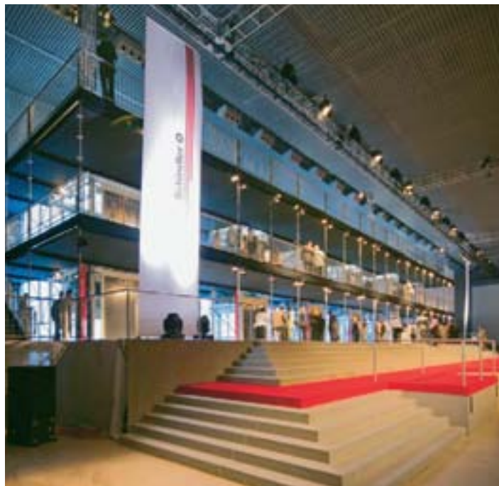
Raumfüllende Bühnenanlage aus dem Combi-Stage-Bühnensystem mit zwölf integrierten Liftschächten.
